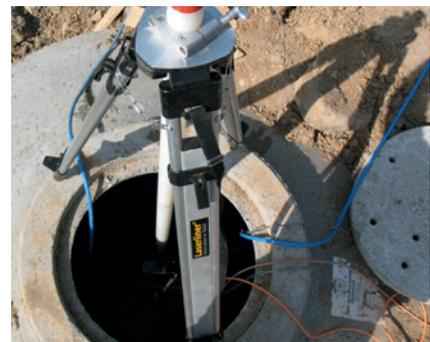
Prüfeinrichtung mit hydrostatischer Messsonde
