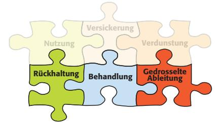
Regenrückhaltebecken werden zur Abflusdämpfung von Niederschlagswasser für die vorübergehende Speicherung eingesetzt. Sie dienen dem Schutz vor hydraulischem Stress bei Gewässern oder Kanalnetzen und ermöglichen eine Begrenzung der Querschnitte von Abflusssystemen.
