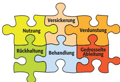
Beim Bau von Gewerbeparks, Verkehrsflächen und Wohngebäuden werden zunehmend dezentrale Anlagen zur Rückhaltung und Behandlung von Niederschlagswasser eingesetzt. Dieses wird dosiert und gereinigt in ein Gewässer eingeleitet oder im Untergrund versickert – eine ökonomische und zugleich ökologische Alternative gegenüber der Mitbehandlung in kommunalen Kläranlagen. Entscheidend für die Verschmutzung von Niederschlagswasser ist die Fläche, auf der das Wasser anfällt. Denn: Die Regenabläufe
