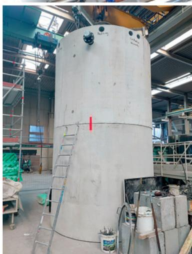
Bei fehlendem Gefälle, hohem Grundwasserspiegel oder sonstigen topografisch ungünstigen Verhältnissen ist die Ableitung von fäkalhaltigen Abwässern und Regenwasser im Freispiegelkanal nicht möglich oder zu teuer. Hier ist eine Mall-Pumpstation die wirtschaftliche Lösung.
