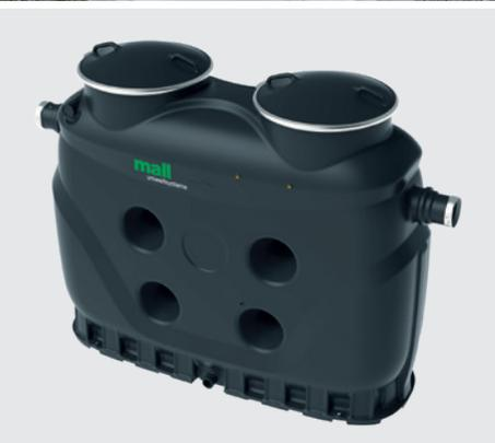
Fettabscheideranlagen nach DIN EN 1825 und DIN 4040-100 sind Bestandteil eines betrieblich geordneten Abfallkonzepts. So müssen die im Abwasser anfallenden tierischen und pflanzlichen Fette und Öle vorbehandelt werden, bevor sie weiter ins Kanalisationssystem gelangen. Nur so können Ablagerungen an den Rohrwandungen und damit Querschnittsverengungen und Verstopfungen der Kanalisationsrohre langfristig vermieden werden.
